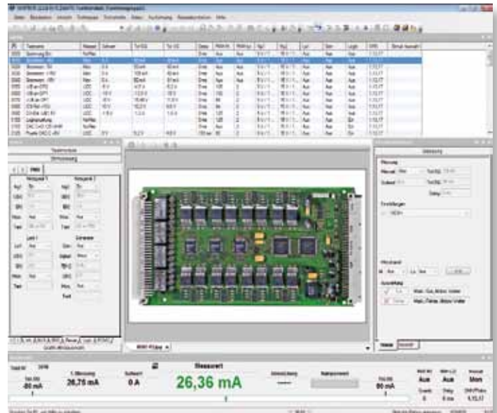
Netzgeräteprogrammierung im Funktionstestformular
