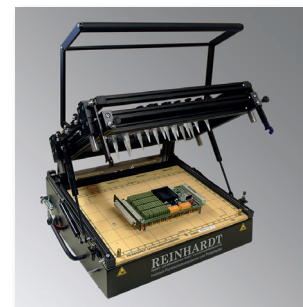
Adapter Typ 42A-2, Andruckkraft 2000 N, Nutzfläche 360 x 230 mm
